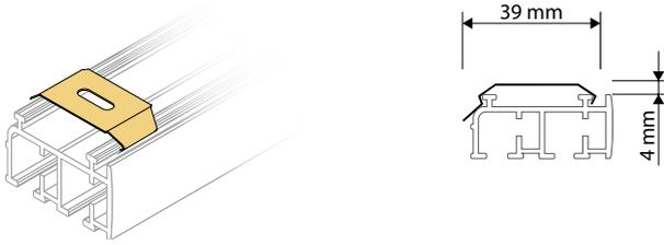
**Halteclip gekröpft mit Langloch** für 2- / 3- Lauf Schiene
