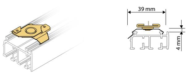
**Schnellmontageclip mit Halteclip gekröpft** für T-Profil 24–26 mm, nur geeignet für Schiene 7620 und 7630
