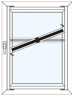
**6. Zuerst obere Spannschühe auf Endkappen schieben – anschließend die Unterer**
