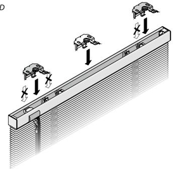
Träger positionieren, festschrauben
