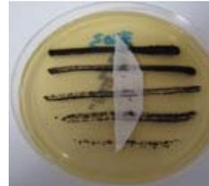
Ohne bakteriostatischer Ausrüstung ist Bewuchs sichtbar.
