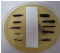
Mit bakteriostatischer Ausrüstung ist **kein** Bewuchs sichtbar.
