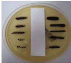
Mit bakteriostatischer Ausrüstung ist **kein** Bewuchs sichtbar.
