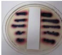
Mit bakteriostatischer Ausrüstung ist **kein** Bewuchs sichtbar.
