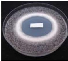
Mit fungistatischer Ausrüstung ist **kein** Bewuchs sichtbar.
