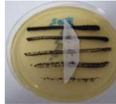
Ohne bakteriostatischer Ausrüstung ist Bewuchs sichtbar.
