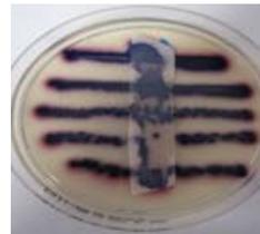
Ohne bakteriostatischer Ausrüstung ist Bewuchs sichtbar.
